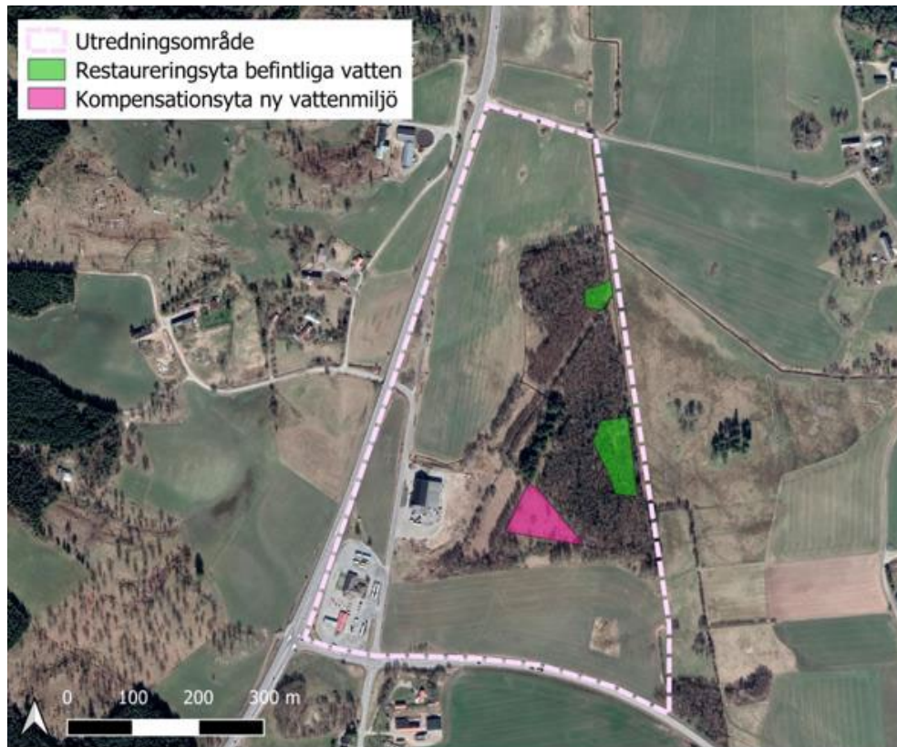
9. Ortofoto med placering av tänkt våtmarkskomplex med damm (rosa polygon), som kompensation för förlust av öppna diken. Gröna ytor är förslag på frivilliga förbättringsåtgärder. (Bild från biotopskyddsansökan, EnviroPlanning, 2022)
