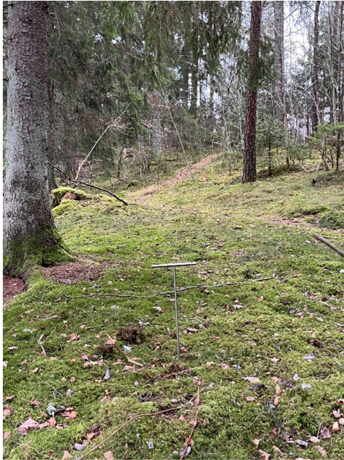
Figur 4. Vy mot söder i skogsområdets norra del. Sticksond stoppslagen mot förmodat berg.
