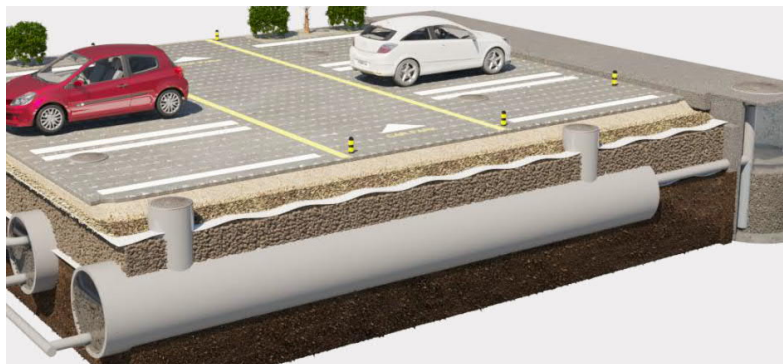
Figur 36. Exempel på fördröjning och rening i rörmagasin. Bildkälla: Weric AB
